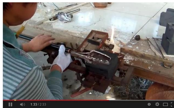
Tehnologija ručnog puhanja
